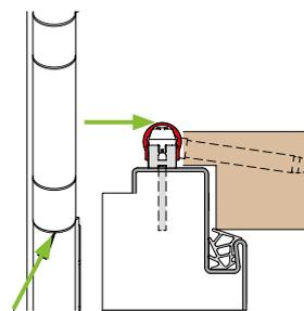
Normkonforme Montage ohne Unterfütterung
